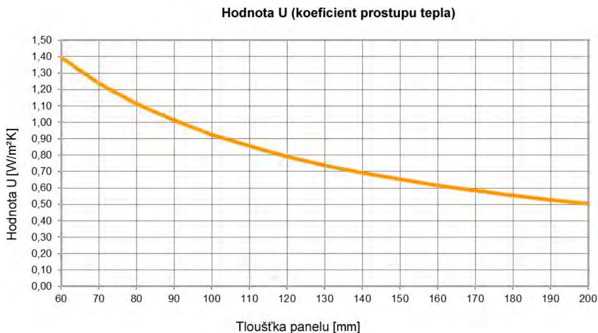
Obrázek 1: Hodnoty U neobložených panelů CLT pro obvodové stěny
